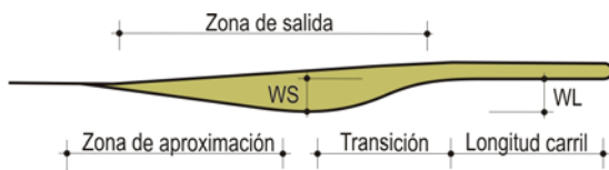
a- Con "sombra" completa: corrimiento lateral \geq ancho de carril de giro
